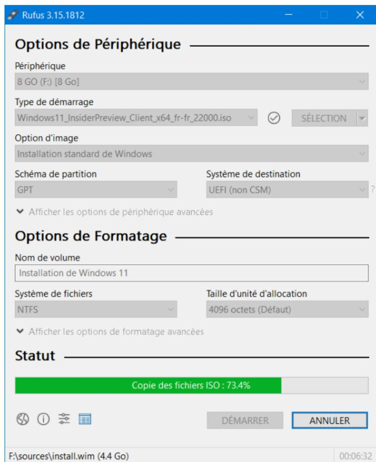
En fonction de votre matériel et de l'image disque à flasher sur la clé USB, la procédure peut durer plus ou moins longtemps, généralement plusieurs minutes. Cliquez enfin sur le bouton **Fermer** lorsque Rufus a terminé la procédure.
